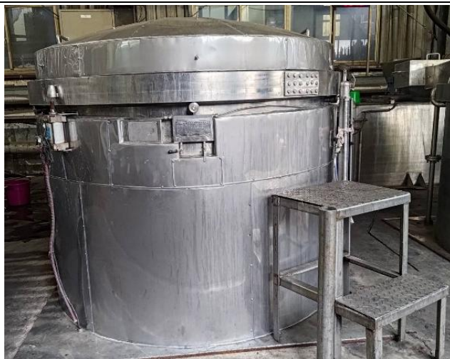
桃園廠染缸安裝缸體保溫材
