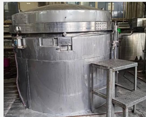
桃園廠染缸安裝缸體保溫材
