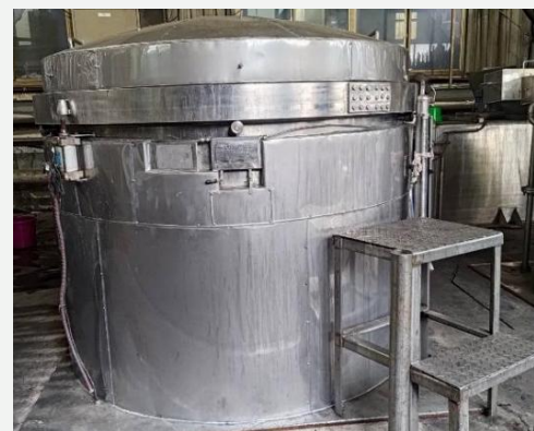
桃園廠染缸安裝缸體保溫材
